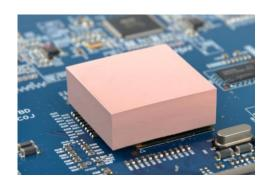
TP600导热硅胶片是一款高导热性能的 材料,双面自粘,与电子组件装配使用时, 低压缩力下表现出较低的热阻和较好的 电气绝缘特性。在-40℃~150℃可以稳 定工作,满足UL94V0的阻燃等级要求。
